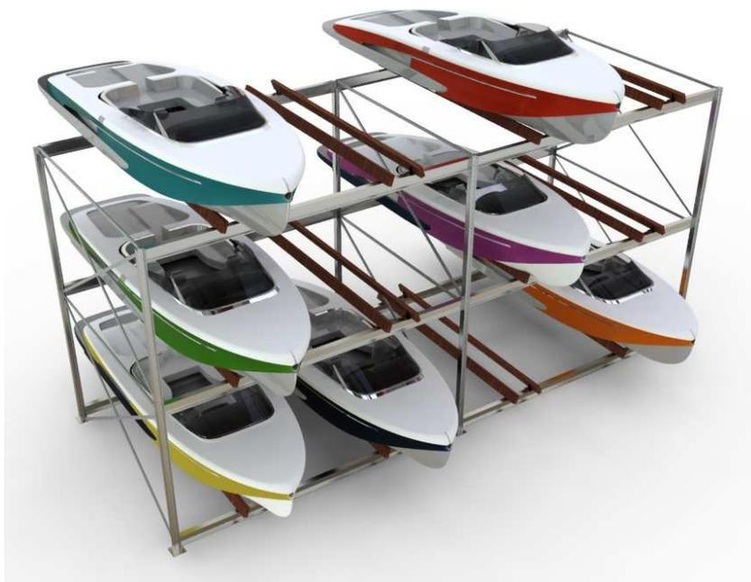
El sistema MSM se basa en una estructura abierta, sin cerramientos ni cubierta. Esta estructura está construida a base de perfiles de acero galvanizado en caliente atornillada para facilitar y optimizar el transporte. Las maderas de soporte de las embarcaciones, pueden desplazarse fácilmente, adaptándose a cualquier tipo de embarcación o forma de casco.
